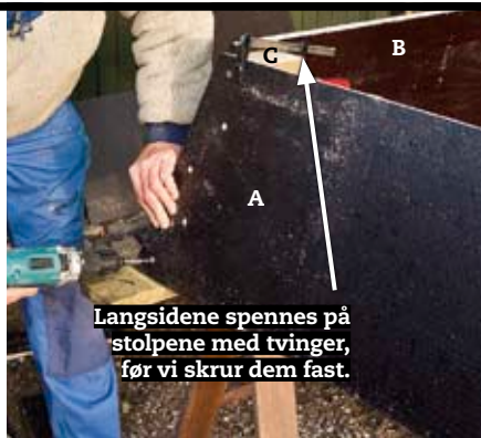
Kassen rettes i vinkel og stabiliseres med en skråstiver, som fjernes når bedet er oppstilt.
